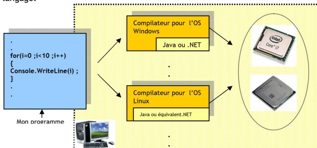
Un programme écrit par exemple en langage C, pourra être « compris » par des machines équipées d'OS (Operating System \_Système d'exploitation\_) différents, voire même de processeurs différents (Advanced Micro Device et Intel par exemple). Il suffit que le compilateur soit adapté... *la participation de AMD et Intel à la conception de tels compilateurs représente également un enjeu économique ...*
